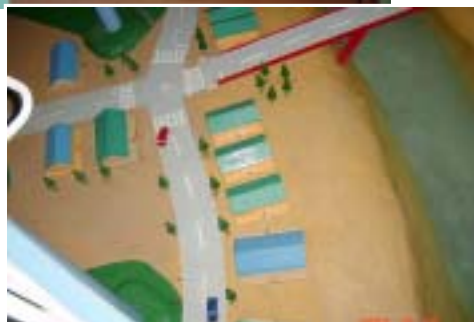
【TSUNAMI ドームシアター】 400インチ相当の大型ドームスクリーン映像と、津波の市街地への遡上がイメージできる縦30m、横10mの屋内津波実験水槽
