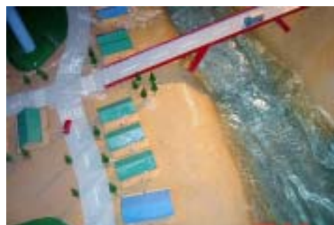
【TSUNAMI ドームシアター】 400インチ相当の大型ドームスクリーン映像と、津波の市街地への遡上がイメージできる縦30m、横10mの屋内津波実験水槽
